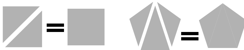
FIG. 3.2 – Pour la 3D maillée, tout est triangles. Pour représenter un polygone, il suffit de le découper.
