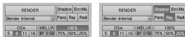
FIG. 6.5 – Deux réglages de rendu entre lesquels on jongle fréquemment tant qu'on travaille au brouillon : à gauche, une grande image calculée rapidement, mais sans ombres portées ; à droite, une toute petite image avec ombres.
